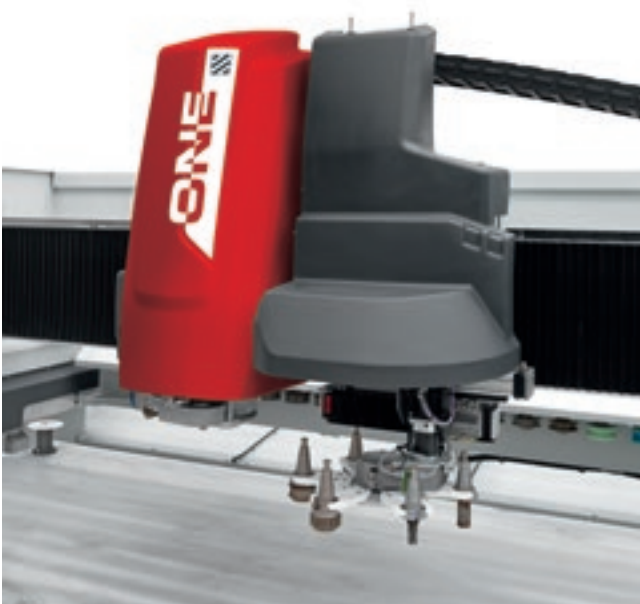
Rückseitiges Werkzeugmagazin mit 23 Positionen.
