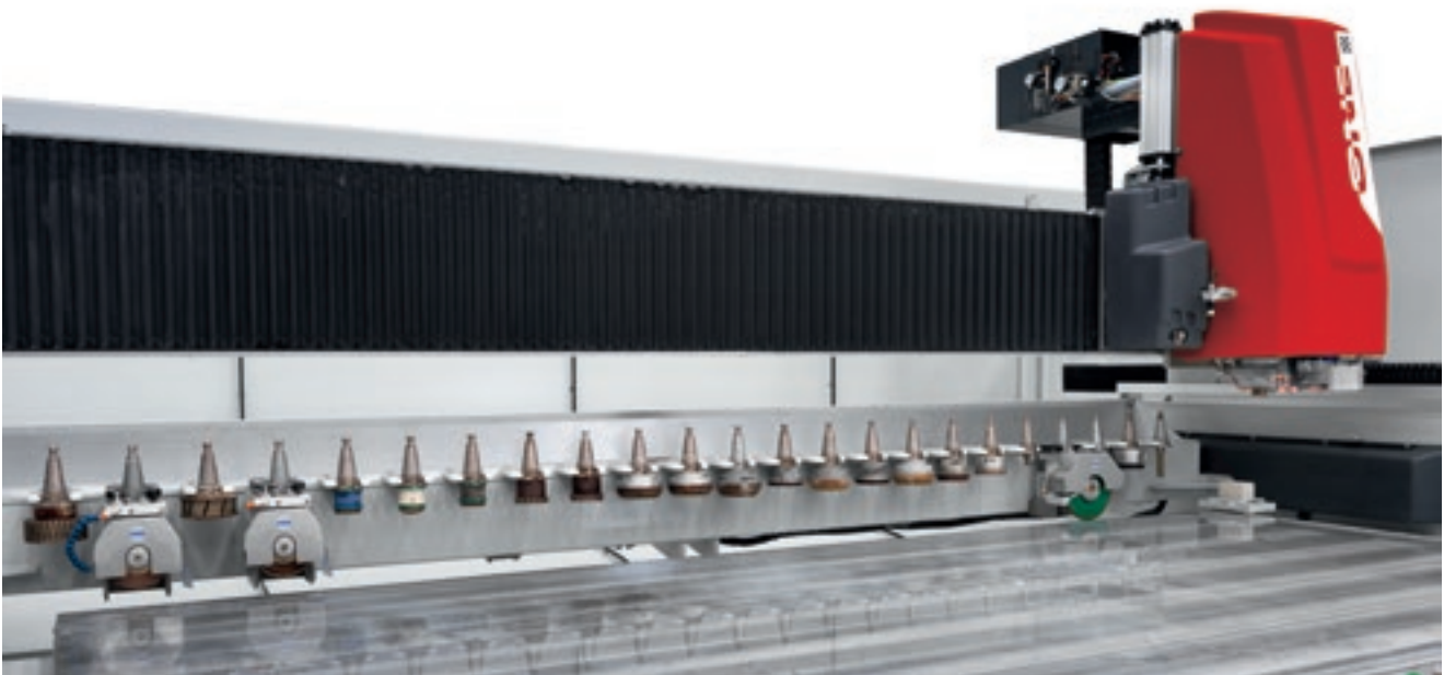
Rückseitiges Werkzeugmagazin mit 23 Positionen.
